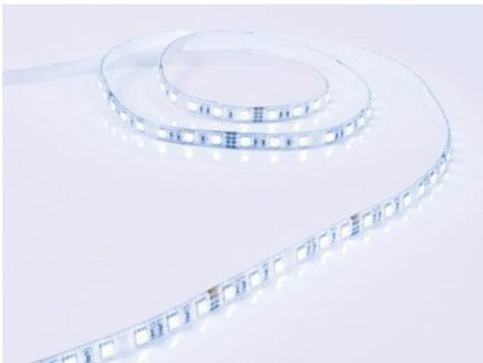
Strip luminoso ad anodo comune contenente 300 LED blu ad alta luminosità, resistente alle intemperie (IP68), flessibile e dotato di base adesiva. Distanza tra LED 16,5 mm. Può essere tagliato ogni 6 LED (10 cm). Utilizzabile con il modulo dimmer 8220-VM152. Può essere alimentato con PSIN10024 e PSIN30024. Lunghezza: 5 metri.
