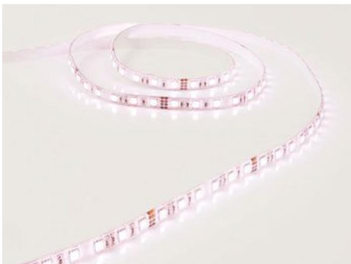
Strip luminoso ad anodo comune contenente 300 LED RGB ad alta luminosità, resistente alle intemperie (IP68), flessibile e dotato di base adesiva. Distanza tra LED 16,5 mm. Può essere tagliato ogni 6 LED (10 cm). Utilizzabile con il controller K8088, VM146, VM151, CHLSC1 e i moduli dimmer VM161 e VM162. Può essere alimentato con PSIN10024 e PSIN30024. Lunghezza: 5 metri.
