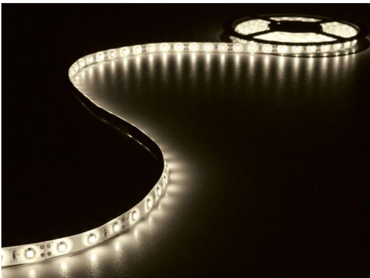
Strip luminoso da interno composto da 300 LED bianchi a luce calda ad alta luminosità (tipo 3528) con angolo di emissione di 120°. Base autoadesiva, sezionabile ogni 3 LED, alimentazione 12 Vdc (adattatore incluso), grado di protezione IP20.
