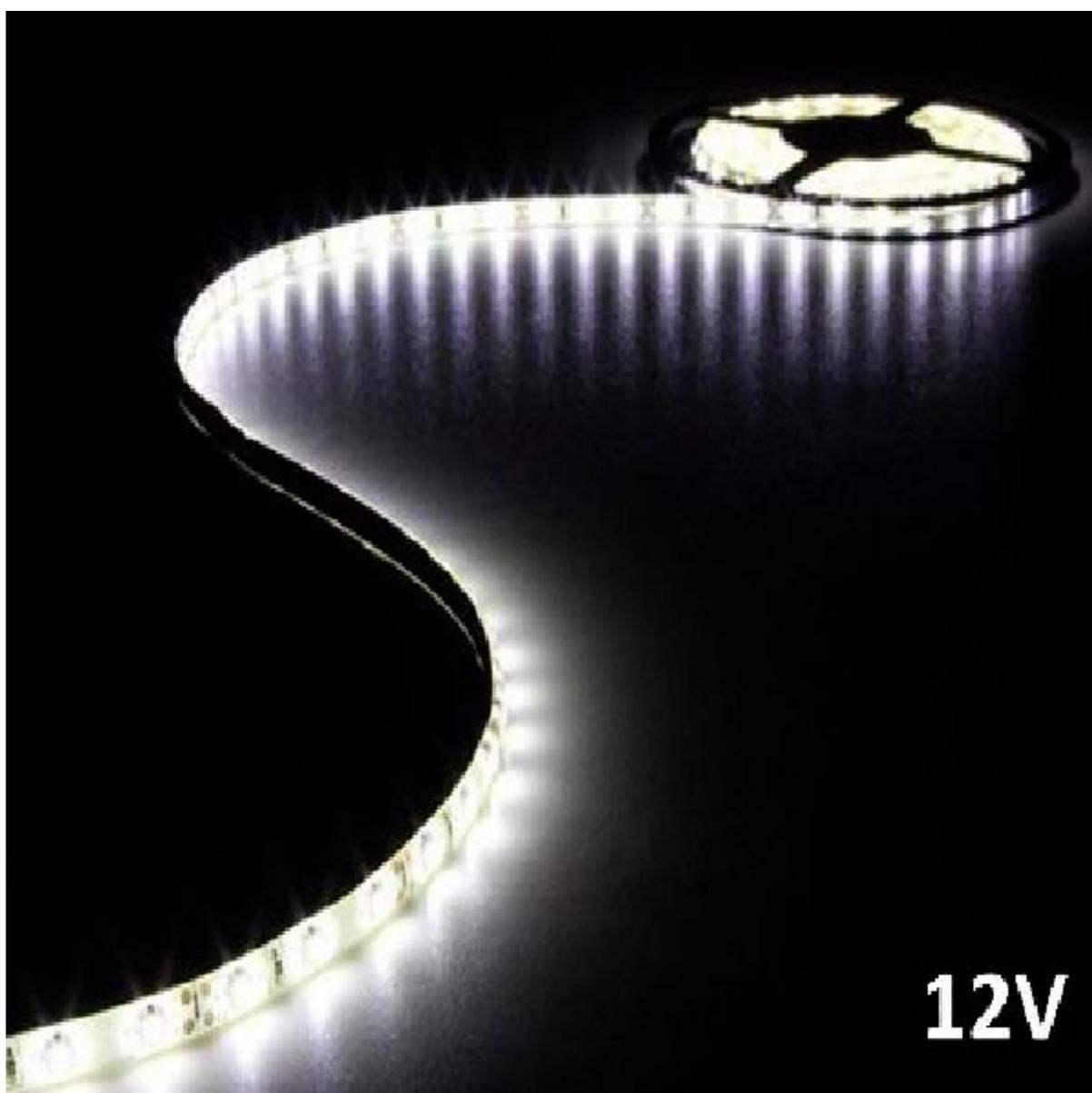
Strip luminoso da esterno IP65, composto da 300 LED bianchi a luce fredda ad altissima luminosità (tipo 5050) con angolo di emissione di 120°. Base autoadesiva, sezionabile ogni 3 LED, alimentazione 12 Vdc. Impiegabile come decorazione luminosa, illuminazione, segnalazione di emergenza, ecc.
