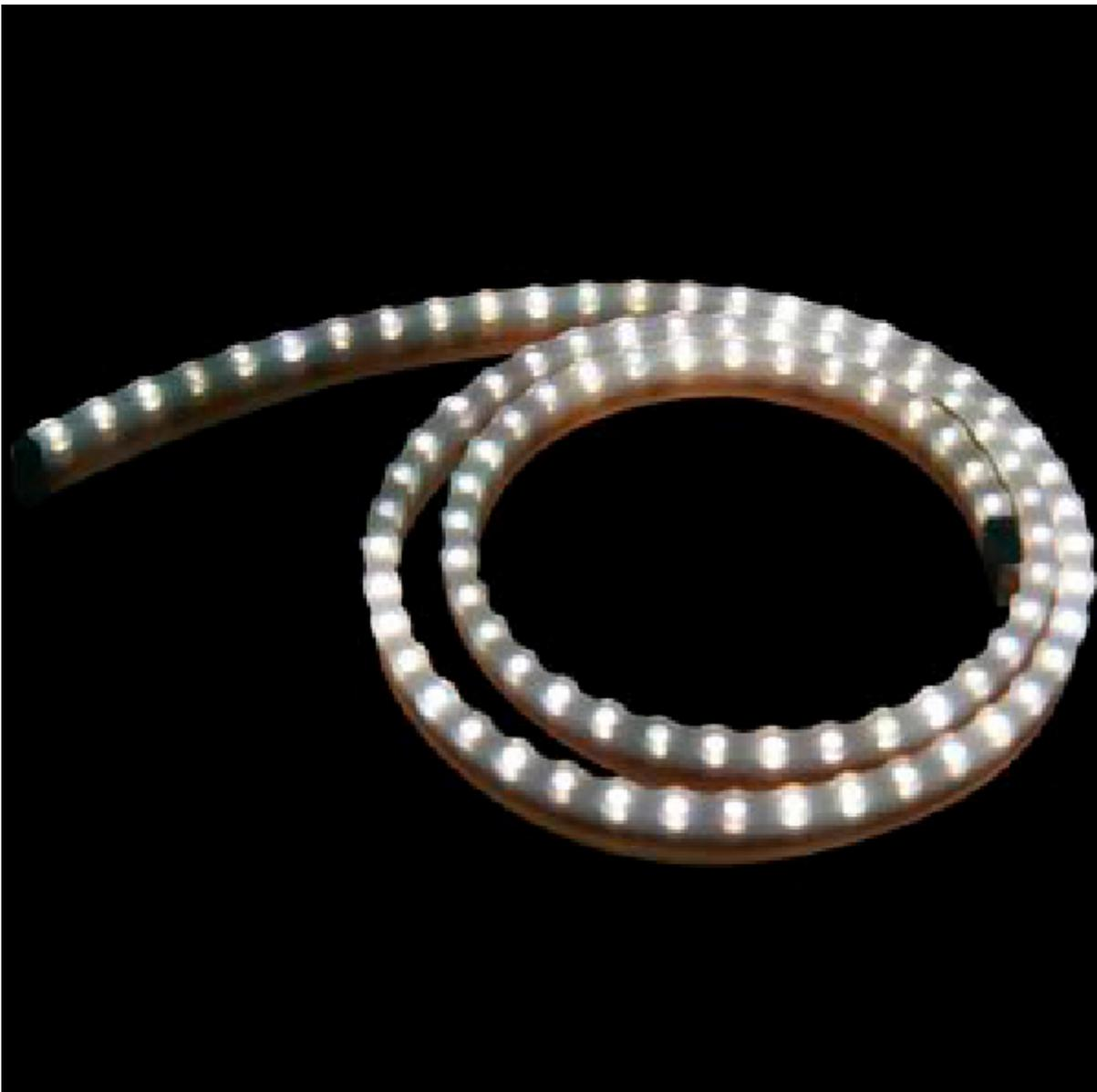
Lunghezza 1 metro. Alimentazione 12 V / 8 W; luminosità 1060 - 1300 mlm. Completo di clip di fissaggio. La striscia può essere tagliata ogni 3 LED.
