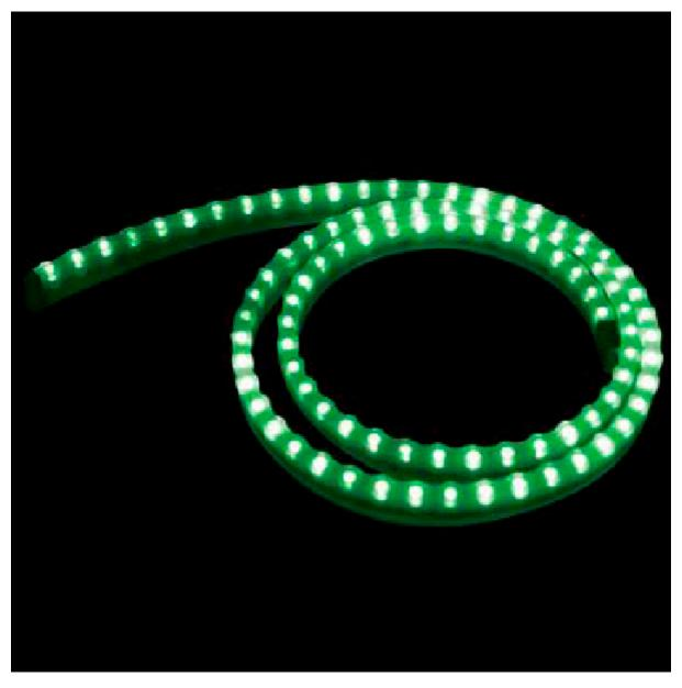
Lunghezza 1 metro. Alimentazione 12 V / 8 W; luminosità 8200 - 9000 mlm. Completo di clip di fissaggio. La striscia può essere tagliata ogni 3 LED.
