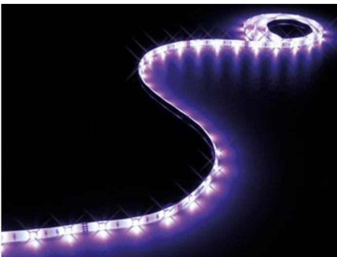
Set contenente uno strip luminoso RGB da 2 metri, un controller e un telecomando IR. Lo strip è ad anodo comune e contiene 60 LED ad alta luminosità (tipo 5050) distanziati tra loro ogni 33 mm. Flessibile e dotato di base adesiva, può essere tagliato ogni 10 cm. Il controller dispone di differenti programmi preimpostati (colore singolo, lampeggio, strobo, dissolvenza, ecc..). Alimentatore indicato (non compreso): 8220-PSS1215.
