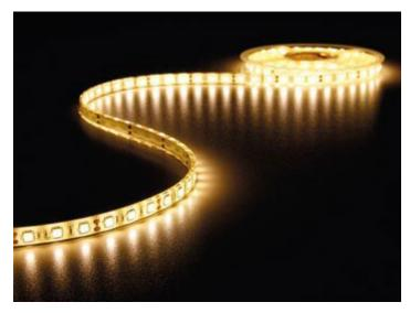
Strip luminoso waterproof (IP68) ad anodo comune contenente 300 LED bianco caldo (tipo 5050) ad alta luminosità, flessibile e dotato di base adesiva. Può essere tagliato ogni 3 LED (5 cm). Utilizzabile con dimmer VM152 (non compreso). Può essere alimentato con PSIN10012, PSIN15012, PSIN30012, LPS04512R e LPS06012R (non compresi). Lunghezza: 5 metri.
