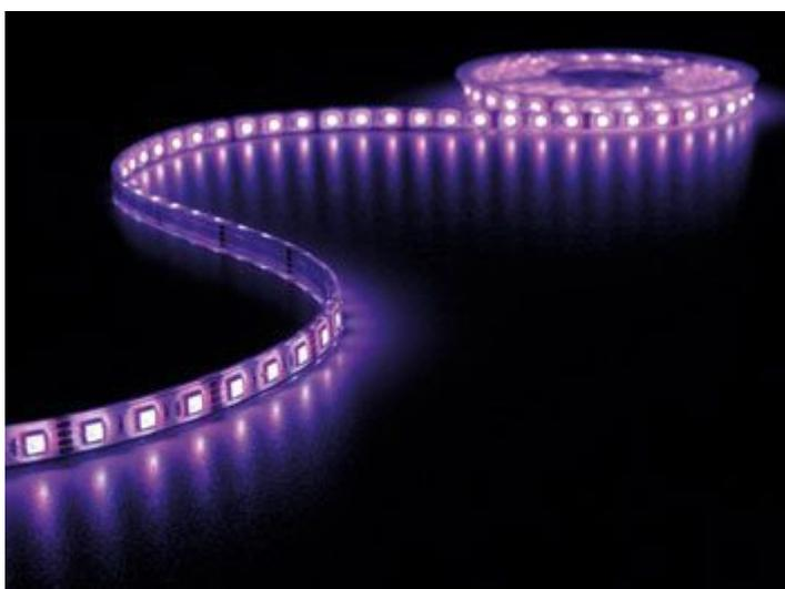
Strip luminoso waterproof (IP68) ad anodo comune contenente 300 LED RGB (tipo 5050) ad alta luminosità, flessibile e dotato di base adesiva. Può essere tagliato ogni 3 LED (5 cm). Utilizzabile con i controller K8088, VM146, VM151 e CHLSC1 (non compresi) o dimmer VM161 e VM162. Può essere alimentato con PSIN06012, PSIN10012, PSIN15012, PSIN30012, LPS04512R e LPS06012R (non compresi). Lunghezza: 5 metri.
