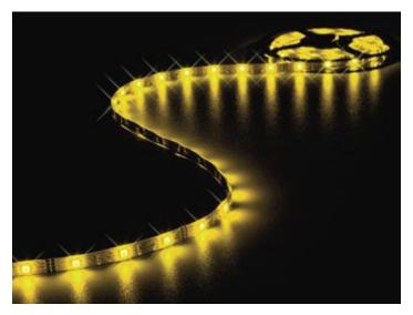
Strip luminoso weatherproof (IP61) contenente 150 LED gialli (tipo 5050) ad alta luminosità, flessibile e dotato di base adesiva. Può essere tagliato ogni 3 LED (10 cm). Utilizzabile con dimmer VM152 (non compreso). Può essere alimentato con LPS04512R e LPS06012R (non compresi). Lunghezza: 5 metri.
