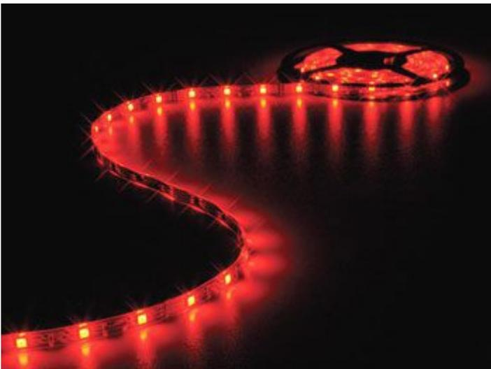
Strip luminoso weatherproof (IP61) contenente 150 LED rossi (tipo 5050) ad alta luminosità, flessibile e dotato di base adesiva. Può essere tagliato ogni 3 LED (10 cm). Utilizzabile con dimmer VM152 (non compreso). Può essere alimentato con LPS04512R e LPS06012R (non compresi). Lunghezza: 5 metri.
