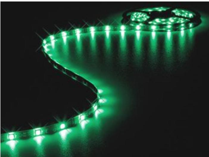
Strip luminoso weatherproof (IP61) contenente 150 LED verdi (tipo 5050) ad alta luminosità, flessibile e dotato di base adesiva. Può essere tagliato ogni 3 LED (10 cm). Utilizzabile con dimmer VM152 (non compreso). Può essere alimentato con LPS04512R e LPS06012R (non compresi). Lunghezza: 5 metri.
