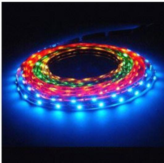
Strip luminoso contenente 150 LED RGB ad alta luminosità, resistente alle intemperie (IP67) e flessibile. Distanza tra LED 33 mm. Può essere tagliato ogni 3 LED. Lunghezza: 5 metri.
