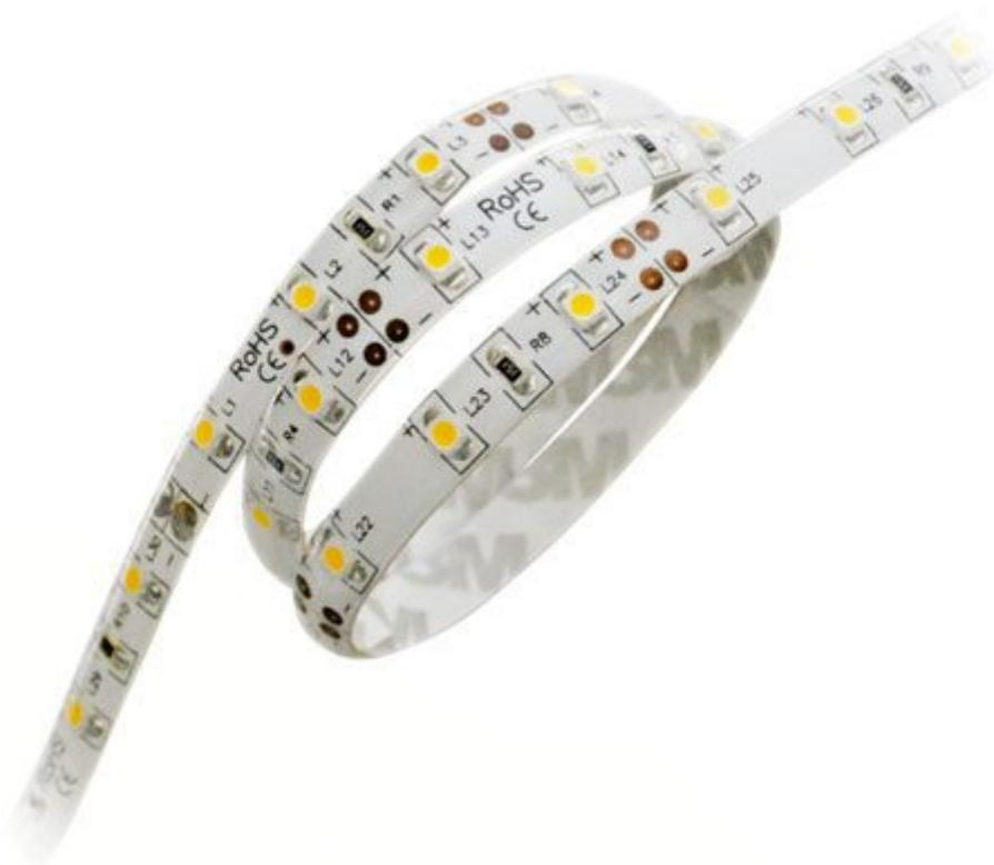
Strip luminoso lungo 5 metri, contenente 300 LED tipo 3528 ultra luminosi di colore bianco caldo. È dimmerabile e può essere tagliato ogni 3 LED per ottenere la misura desiderata. Il basso consumo permette infinite applicazioni e forme tramite i controller e radiocomandi. Alimentazione: 12 Vdc.
