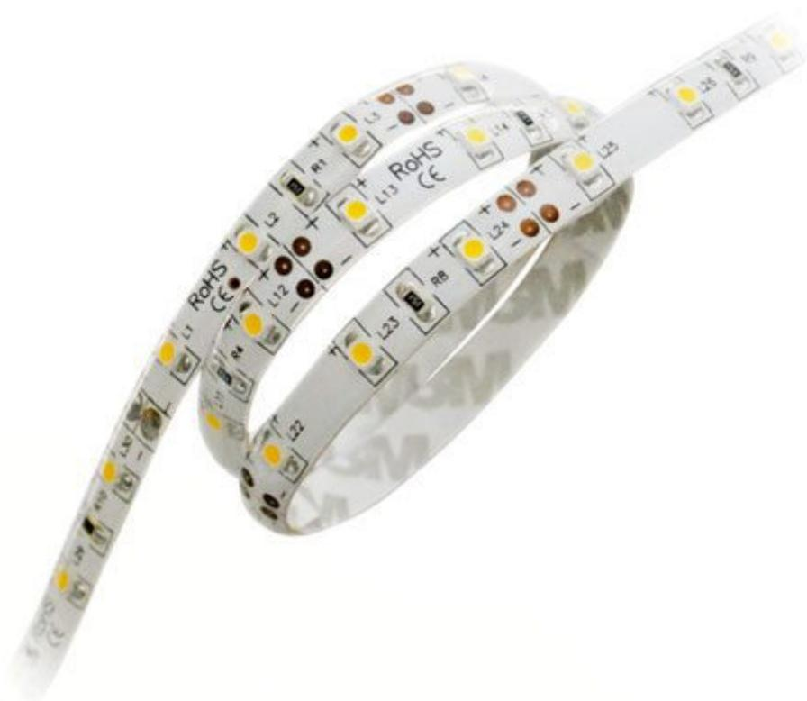
Strip luminoso lungo 5 metri, contenente 300 LED tipo 3528 ultra luminosi di colore bianco freddo. È dimmerabile e può essere tagliato ogni 3 LED per ottenere la misura desiderata. Il basso consumo permette infinite applicazioni e forme tramite i controller e radiocomandi. Alimentazione: 12 Vdc.
