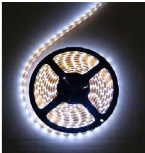
Strip luminoso contenente 300 LED bianchi ad alta luminosità (1500 mcd), resistente alle intemperie (IP68) e flessibile. Distanza tra LED 17 mm. Può essere tagliato ogni 3 LED. Lunghezza: 5 metri.
