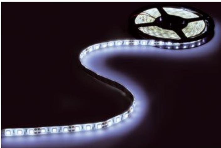
Strip luminoso waterproof (IP64) contenente 300 LED bianchi Tri-chip (tipo 5060 SMD) super luminosi, flessibile e dotato di base con adesivo 3M. Distanza tra LED 17 mm. Può essere tagliato ogni 3 LED. Lunghezza: 5 metri. Può essere alimentato con PSIN10012, PSIN15012, PSIN30012 (non compresi).
