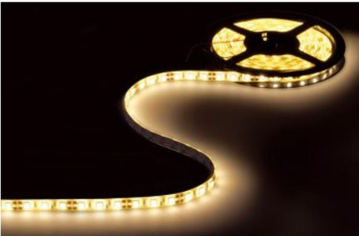
Strip luminoso waterproof (IP54) contenente 300 LED bianco caldo Tri-chip (tipo 5060 SMD) super luminosi, flessibile e dotato di base con adesivo 3M. Distanza tra LED 17 mm. Può essere tagliato ogni 3 LED. Lunghezza: 5 metri. Può essere alimentato con PSIN10012, PSIN15012, PSIN30012 (non compresi).
