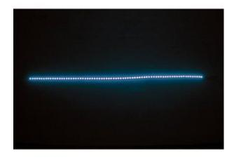
Striscia adesiva con 78 LED blu ad alta luminosità con emissione angolare di 120°. Adatta per realizzare segnalazioni luminose pubblicitarie o per indicare situazioni potenzialmente pericolose. Base autoadesiva per fissaggio rapido. Può essere tagliata ogni 1,5 cm. Utilizzabile con dimmer per strisce LED (non compreso): 8220-VM152. Alimentazione 12 Vdc. Alimentatori consigliati (non compresi): 8220- PSIN02512, 8220- PSIN06012, 8220- PSIN10012, 8220- PSIN10012.
