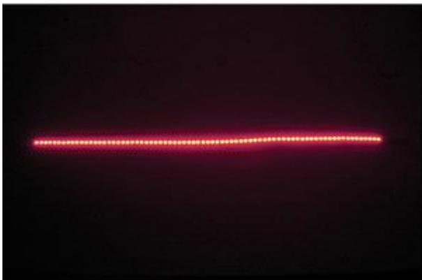
Striscia adesiva con 78 LED rossi ad alta luminosità con emissione angolare di 120°. Adatta per realizzare segnalazioni luminose pubblicitarie o per indicare situazioni potenzialmente pericolose. Base autoadesiva per fissaggio rapido. Può essere tagliata ogni 1,5 cm. Utilizzabile con dimmer per strisce LED (non compreso): 8220-VM152. Alimentazione 12 Vdc. Alimentatori consigliati (non compresi): 8220- PSIN02512, 8220- PSIN06012, 8220- PSIN10012, 8220- PSIN15012, 8220- PSIN30012.
