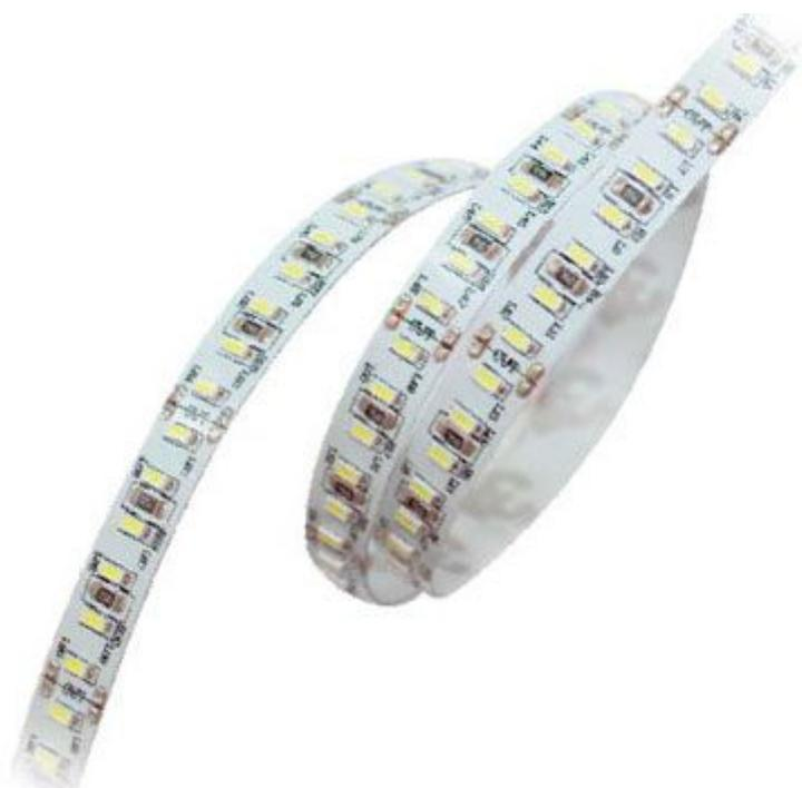
Strip luminoso waterproof (IP64) contenente 600 LED bianco freddo Tri-chip (tipo 3014 SMD) super luminosi, flessibile e dotato di base con adesivo 3M. Distanza tra LED 8 mm. Può essere tagliato ogni 6 LED. Lunghezza: 5 metri.
