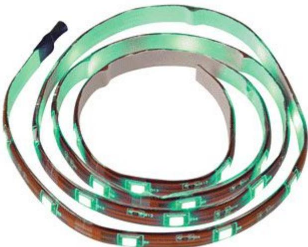
Alta luminosità con angolo di emissione di 120°. Adatta per realizzare segnalazioni luminose di emergenza o per indicare situazioni potenzialmente pericolose. Resistente alle intemperie. Base autoadesiva per fissaggio rapido. Può essere tagliato ogni 3 LED. Utilizzabile con i seguenti prodotti: K8088, VM146, VM151, VM161 e VM162.
