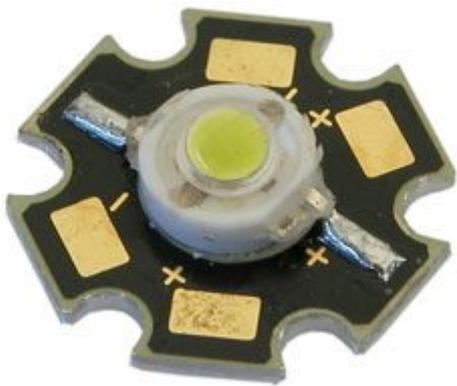
Super Led bianco modello lambertiano, contenitore Luxeon® Star (esagonale), potenza 3 W, oltre 50.000 ore di funzionamento. Colore bianco, temperatura colore: 6000~8000K, flusso luminoso: 120 lumen, resistenza termica: 48°C/W, alimentazione: 3,5 Vdc, corrente: 700 mA. Per il pilotaggio utilizzare il kit K8071 o la versione montata codice VM143/3W.
