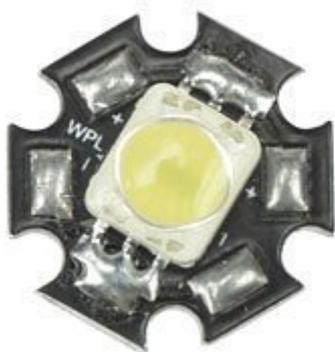
Super Led giallo ambra ad alta luminosità, potenza 3 W, oltre 50.000 ore di funzionamento. Colore giallo ambra, lunghezza d'onda dominante: 590 nm , flusso luminoso: 30 lumen, angolo di osservazione: 90°, resistenza termica: 48°C/W, alimentazione: 3,2 Vdc, corrente: 1 A, montaggio: SMT, nessuna emissione UV. Per il pilotaggio utilizzare il kit K8071 o la versione montata codice VM143/3W. Non utilizzare il LED senza un dissipatore (non compreso).
