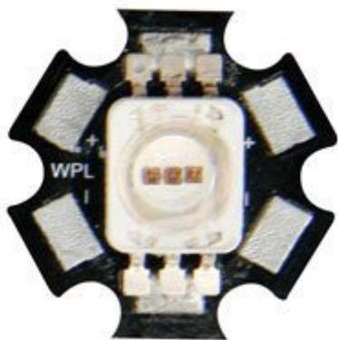
Super Led verde ad alta luminosità, potenza 3 W, oltre 50.000 ore di funzionamento. Colore verde, lunghezza d'onda dominante: 520 nm, flusso luminoso: 170 lumen, angolo di osservazione: 140°, resistenza termica: 48°C/W, alimentazione: 3,5 Vdc, corrente: 1 A, montaggio: SMT, nessuna emissione UV. Per il pilotaggio utilizzare il kit K8071 o la versione montata codice VM143/3W. Non utilizzare il LED senza un dissipatore (non compreso).
