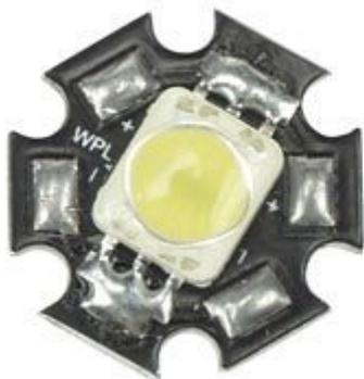
Super Led verde ad alta luminosità, potenza 3 W, oltre 50.000 ore di funzionamento. Colore verde, lunghezza d'onda dominante: 520 nm , flusso luminoso: 90 lumen, angolo di osservazione: 90°, resistenza termica: 48°C/W, alimentazione: 3,2 Vdc, corrente: 1 A, montaggio: SMT, nessuna emissione UV. Per il pilotaggio utilizzare il kit K8071 o la versione montata codice VM143/3W. Non utilizzare il LED senza un dissipatore (non compreso).
