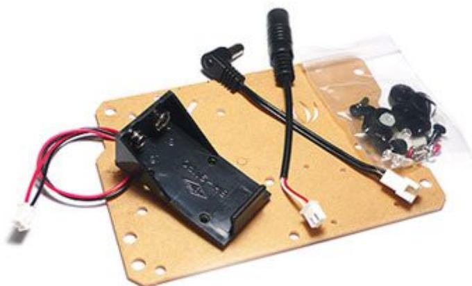
Supporto trasparente per Arduino Uno, Mega e la famiglia Seeduino. La confezione contiene: 1 supporto trasparente, 1 portapila 9V con connettore JST a 2 poli, 4 piedini in gomma, 1 cavetto con presa DC (2,1 mm) da un lato e plug JST 2 poli dall'altro, 1 cavetto con spina DC da un lato e con connettore JST a 2 poli dall'altro, 3 viti+dado per il fissaggio del portapila e 4 rivetti plastici per il fissaggio della scheda. Dimensioni: 130 x 90 mm.
