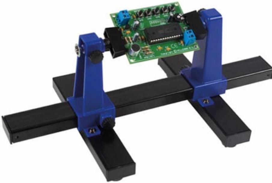
Leggero e facile da trasportare, questo prodotto permette di sorreggere e bloccare, tramite due morsetti che possono ruotare di 360°, una scheda elettronica (con dimensioni max 20x14 cm), consentendo di avere entrambe le mani libere per lavorarci sopra. Dispone inoltre di piccole manopole per regolare la distanza tra i due bracci con i morsetti. Dimensioni (cm): 30x16,5x12,5, peso: 450 grammi.
