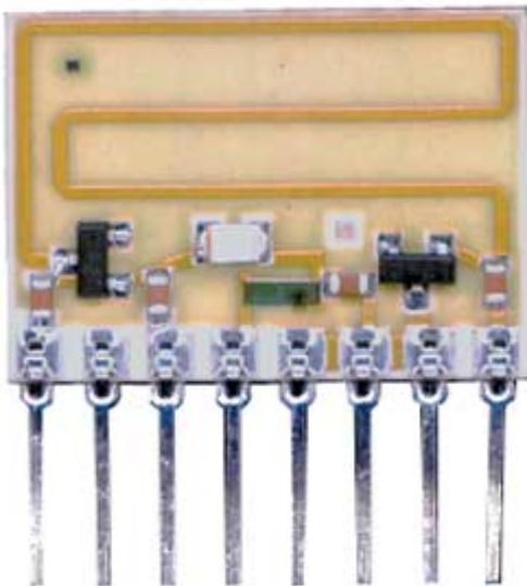
Modulo per la comunicazione elettronica di un'antenna, senza contatti meccanici ad elevata velocità. Consente di abbinare in un sistema Rx-Tx un qualsiasi ricevitore ed un qualsiasi trasmettitore della linea TOTEM. Frequenza: 433,920 MHz; banda passante 20 MHz, velocità di commutazione inferiore a 100  $\mu$ sec.
