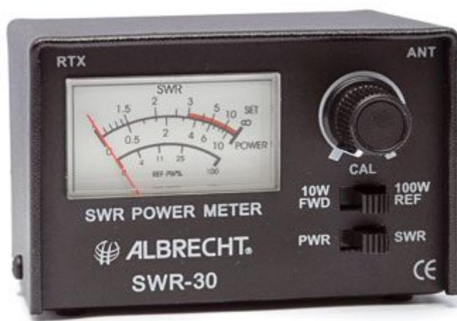
L' SWR30 è uno strumento che permette di misurare e tenere sotto controllo il corretto funzionamento del ricetrasmittitore e dell'impianto radiante dell'antenna (ROS). Permette inoltre di monitorare la potenza di uscita. Frequenza SWR: 3,5 MHz - 50 MHz, frequenza Power: 26 - 30 MHz, dimensioni: L86xH57xP51mm. L'unità dispone di due connettori UHF SO-239.
