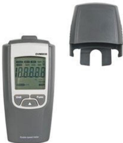
Dotato di puntatore laser, questo tachimetro digitale permette di misurare, senza contatto, la velocità angolare di alberi motore, ruote dentate e pulegge. Unità di misura rpm e rps. Gamma di misurazione da 100 a 30.000 rpm (1.7~500 rps); risoluzione 0,1 rpm (0,1 rps) 0,1°C. Alimentazione 3 batterie 1,5 V AAA (incluse).
