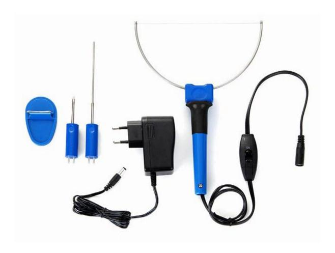
Originale attrezzo per ritagliare dal polistirolo qualsiasi forma. Dispone di tre punte intercambiabili (filo, punta a coltello e punta per incisione). Alimentazione: 5 Vdc / 1500 mA (tramite adattatore da rete 220 vac), tempo di riscaldamento 10 secondi.
