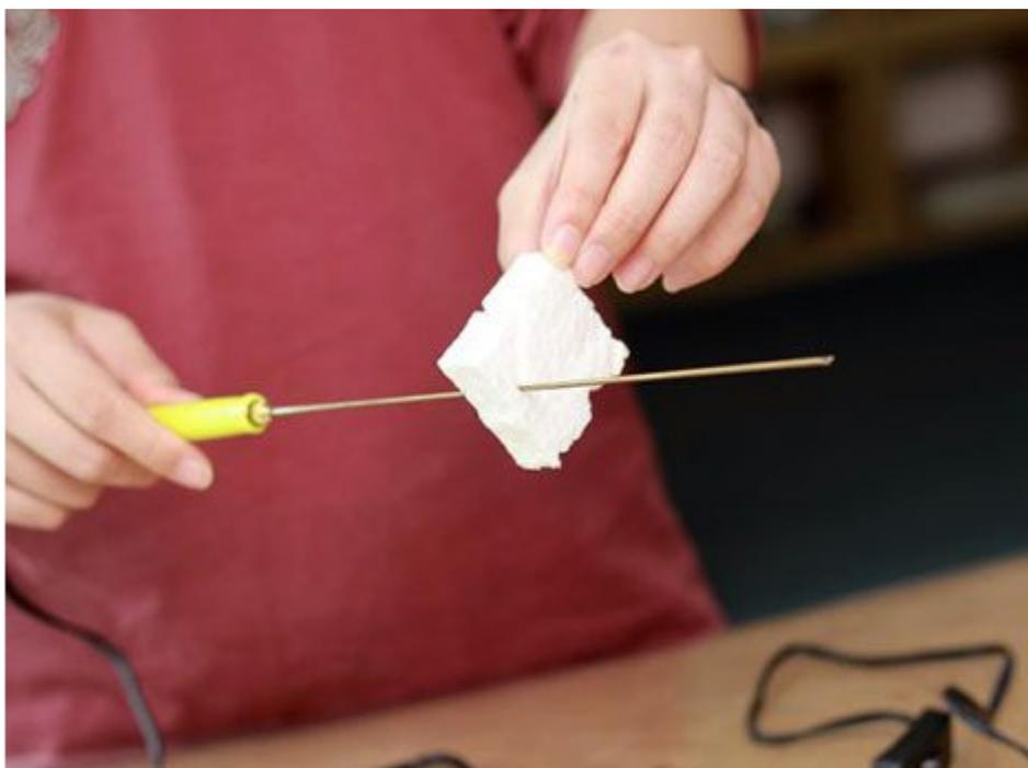
Originale attrezzo per ritagliare dal polistirolo qualsiasi forma. Alimentato in bassa tensione (6 Vdc - 1,5 A), tramite adattatore di rete, si riscalda a 210°C in soli 10 secondi. È portatile, leggero (pesa solo 40 grammi) e il cavo di alimentazione dispone di interruttore on/off.
