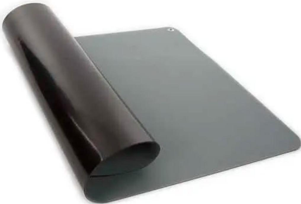
Tappetino antistatico particolarmente indicato per posizionare e manipolare componenti o schede elettroniche. Viene fornito completo di cavo di collegamento messa terra. Resistività superficiale:  $10^7 \sim 10^{10}$  ohm/m<sup>2</sup>, tempo decadimento carica statica: <0,03 secondi.
