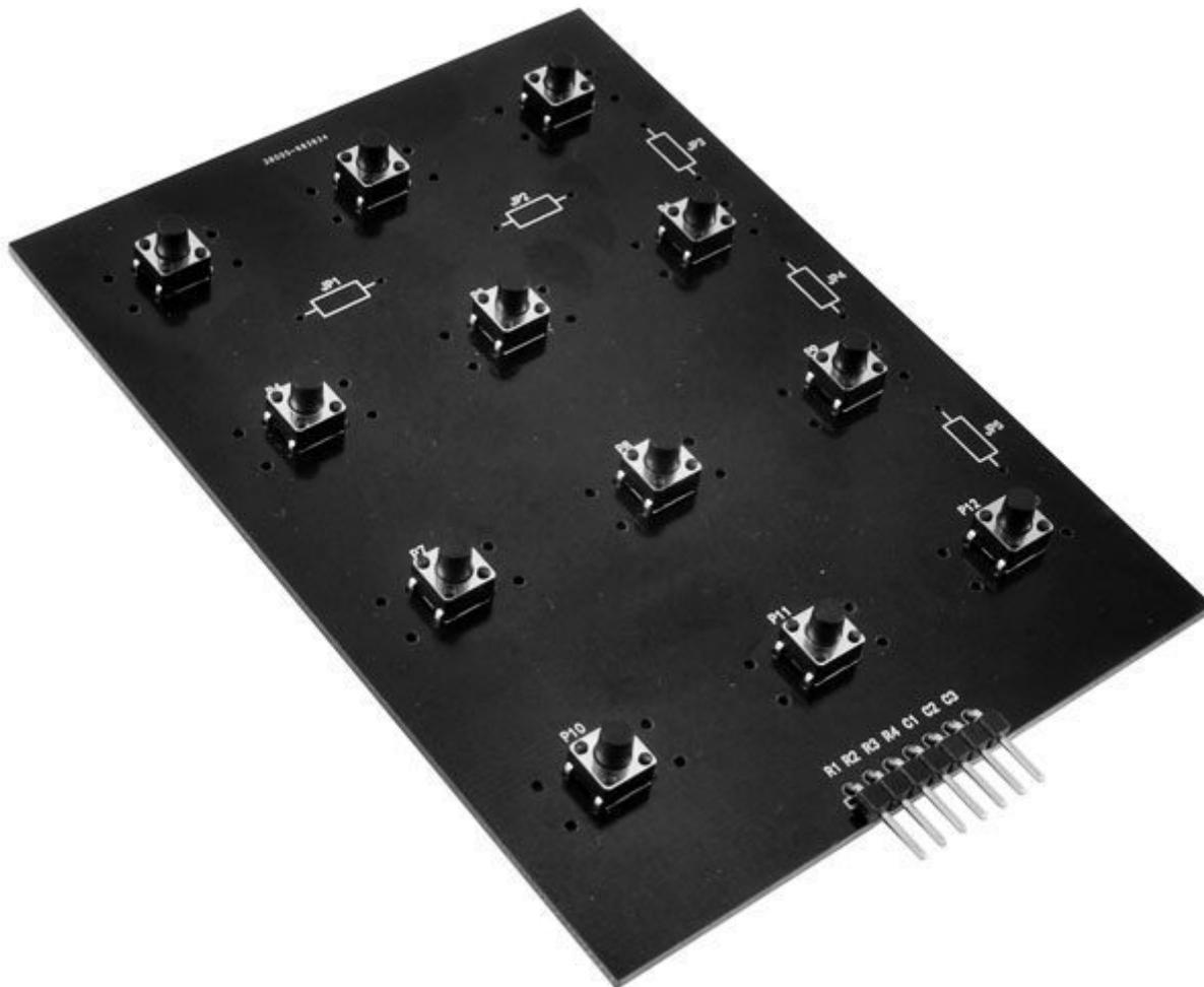
Tastiera composta da 12 pulsanti collegati a matrice (4 righe x 3 colonne) e connettore a 7 pin passo 2,54 mm. La tastiera può anche essere utilizzata come sensore di pressione: realizzando i ponticelli previsti nel circuito, tutti i pulsanti verranno messi in parallelo, pertanto la pressione di anche uno solo di questi può attivare un allarme. Dimensioni (mm): 106x76x9.
