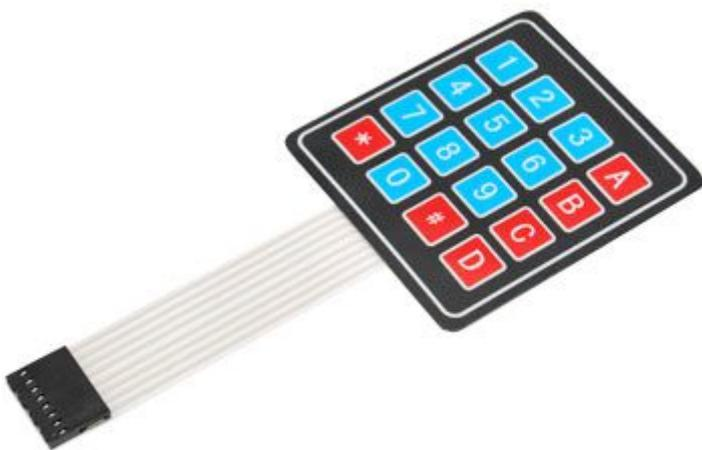
Tastiera a membrana riga/colonna dotata 16 tasti e base adesiva. Utilizzando un microcontrollore è possibile, effettuando la scansione degli 8 pin di uscita, verificare quale dei 16 tasti è stato premuto.
