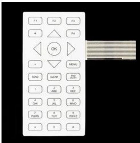
Tastiera a matrice super sottile dotata 27 tasti e base adesiva. Utilizzando un microcontrollore è possibile, effettuando la scansione dei 13 pin di uscita, verificare quale dei 27 tasti è stato premuto. Dimensioni: 94,5 x 46,9 x 1 mm. La tastiera non comprende il connettore da circuito stampato (acquistabile separatamente codice [7300-CONNTSTMEMB](#)).
