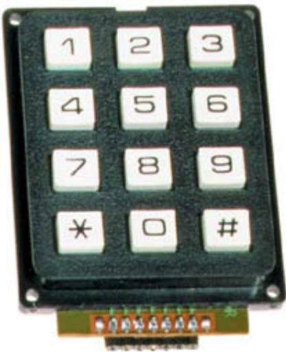
Tastiere a matrice 3x4 pulsanti disposti secondo lo standard degli apparecchi telefonici. I collegamenti a matrice dei pulsanti sono riportati su un basetta posteriore a passo 2,54 mm. Le tastiere sono a tenuta di polvere. Dimensioni: 46 x57 mm.
