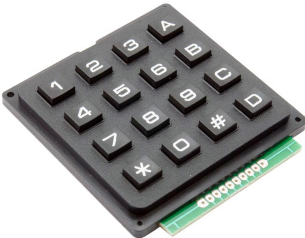
Tastiere a matrice 4x4 pulsanti disposti secondo lo standard degli apparecchi telefonici. I collegamenti a matrice dei pulsanti sono riportati su un basetta posteriore a passo 2,54 mm. Le tastiere sono a tenuta di polvere. Dimensioni (mm): 60x57x10.
