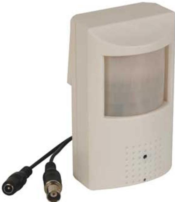
Telecamera CCD a colori inserita all'interno di un sensore PIR ed attivata dallo stesso. La telecamera dispone di obiettivo 3,7 mm Pinhole, 500 linee TV, rapporto S/N maggiore di 48 dB e sensibilità 0,01 Lux. Il sensore PIR ha una portata di rilevamento di 7 metri e comanda l'attivazione del video. Staffa in dotazione. Alimentazione 12 Vdc. **N.B.** alimentatore non compreso.
