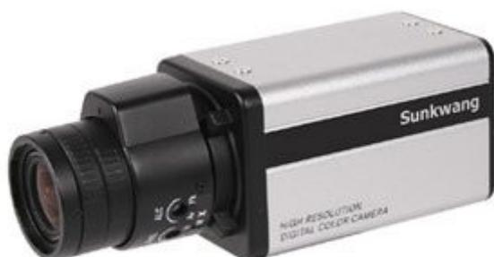
Telecamera a colori ad altissima risoluzione con attacco C/CS dotata di sensore CCD 1/3" SONY COLOR EXview HAD e controllo automatico del guadagno. La telecamera ha una risoluzione di 520 linee TV (SONY HQ1) e una sensibilità di 0,05 Lux; può utilizzare ottiche a diaframma fisso o auto-iris; alimentazione 12 Vdc. La confezione comprende: la telecamera e una ghiera adattatrice (per ottiche con attacco "C"). Non è compreso l'obiettivo.
