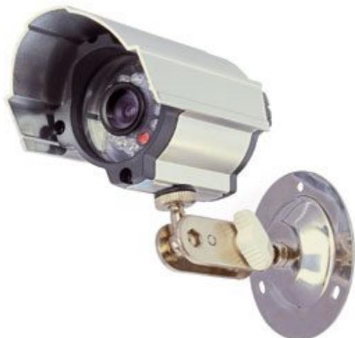
Telecamera con sensore Sharp CCD da 1/4" a colori resistente alle intemperie (livello di protezione IP66) che consente riprese all'esterno senza dover ricorrere agli appositi contenitori a tenuta stagna. Dispone di 12 led infrarossi che si attivano in presenza di scarsa luminosità che ne permettono l'utilizzo anche in condizioni di buio assoluto. La confezione comprende la telecamera e l'adattatore di rete, non è compresa la staffa di fissaggio.
