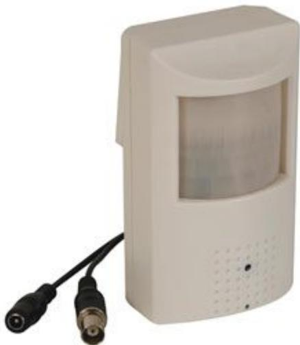
Telecamera a colori occultata all'interno di un sensore PIR (non funzionante). Dispone di sensore CCD a colori 1/4", ottica f3.7mm pinhole, apertura angolare 67° e risoluzione di 420 linee TV. Alimentazione: 12 Vdc, consumo: 100 mA, dimensioni (mm): 119 x 70 x 40. N.B. la confezione non comprende l'alimentatore.
