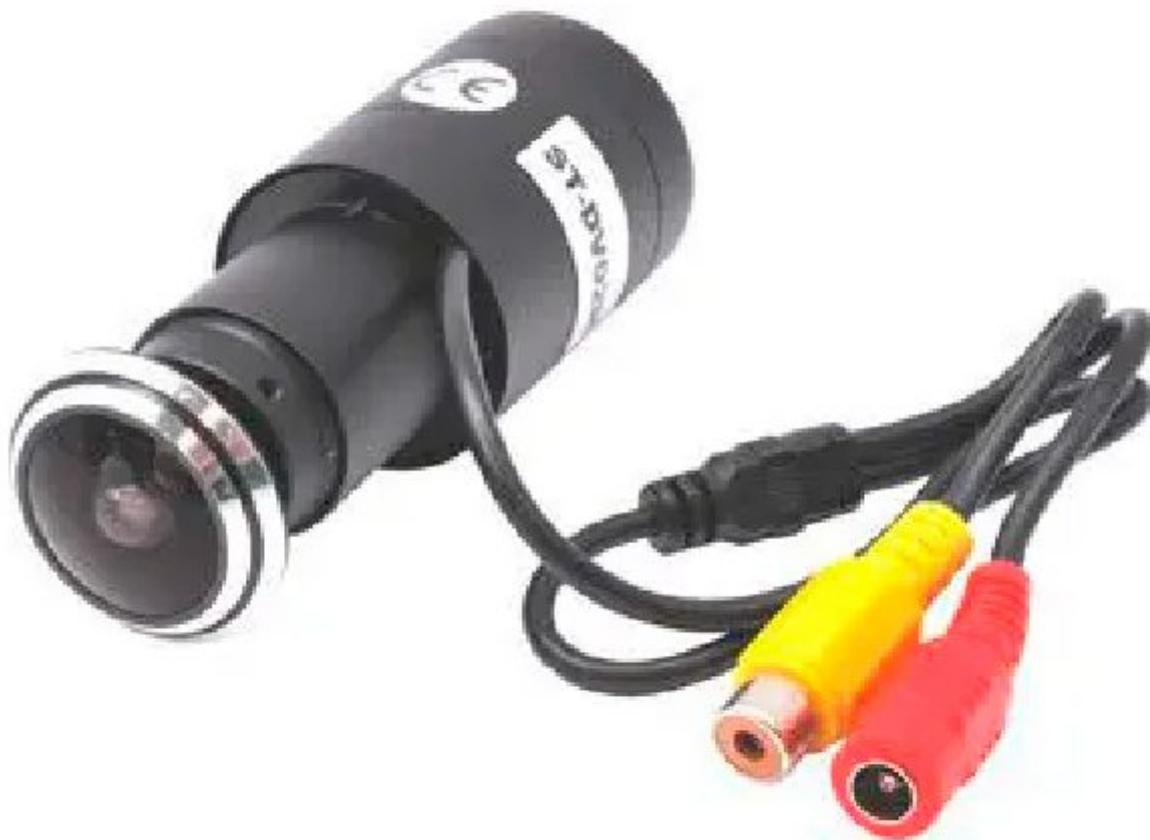
Telecamera a colori 4 in 1 da 2 Mpx appositamente realizzata per essere inserita al posto del tradizionale spioncino della porta. Dotata di un corpo cilindrico allungabile che ne permette l'inserimento in porte con spessore compreso tra 39 e 90 mm. Per poter variare la tipologia di segnale in uscita (CVI/TVI/AHD/CVBS) deve essere utilizzato un DVR o un dispositivo idoneo per poter accedere al menu della telecamera. **N.B.** non è compreso l'alimentatore (vedere prodotti correlati).
