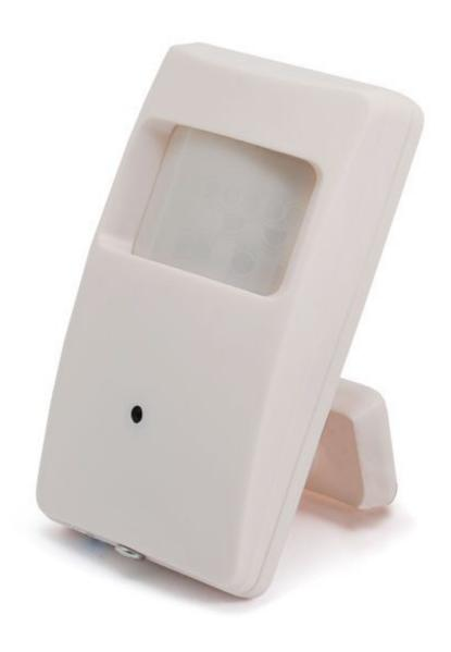
Telecamera a colori CMOS IMX 225 Sony 1/3" integrata al'interno di un sensore PIR. Quando un soggetto entra nel raggio d'azione del sensore PIR, la telecamera si attiva per il tempo impostato. Anche l'uscita a relè disponibile si attiva per lo stesso periodo di tempo.
