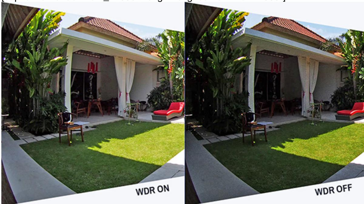
La telecamera IP utilizza la tecnologia Wide Dynamic Range (WDR) 120 dB, che gestisce una gamma dinamica estesa per catturare dettagli chiari sia nelle aree molto luminose che in quelle molto scure. Questa caratteristica garantisce immagini dettagliate e ben definite, indipendentemente dalle condizioni di illuminazione. [/caption]
