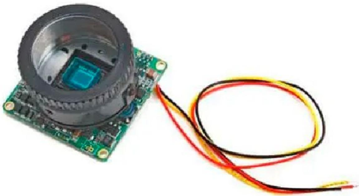
Modulo telecamera colori CCD 1/4" di ottime prestazioni caratterizzata da dimensioni contenute e da controllo dell'immagine realizzato con un DSP.
