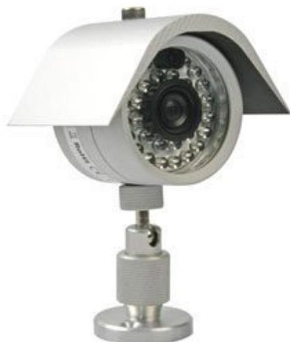
Telecamera a colori da esterno (IP68) con sensore da 1/3" CCD Sony ultra-high sensitivity. Dotata di ottica f=3,6 mm / F2.0, apertura angolare: 79°, risoluzione di 420 linee TV, 0,05 lux (IR off). L'illuminatore IR, formato da 30 led infrarossi, si attiva automaticamente al buio permettendo una visione ottimale anche di notte o in presenza di scarsissima luce. La telecamera viene fornita completa di staffa di fissaggio in metallo.
