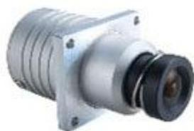
Telecamera a colori di piccolissime dimensioni facilmente occultabile. Realizzata in tecnologia CCD, presenta una risoluzione di 520 linee TV e misura appena 43 x 22 millimetri. Ottica 3,6 mm / F=2.0, alimentazione 12 Volt.
