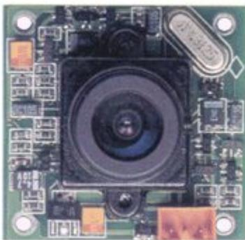
Modulo telecamera CCD B/N da 1/3" con buona definizione e sensibilità. Risoluzione: 400 linee; otturatore: Auto iris. Ottica: 8 mm; apertura angolare: 40°. Alimentazione: 12 V.
